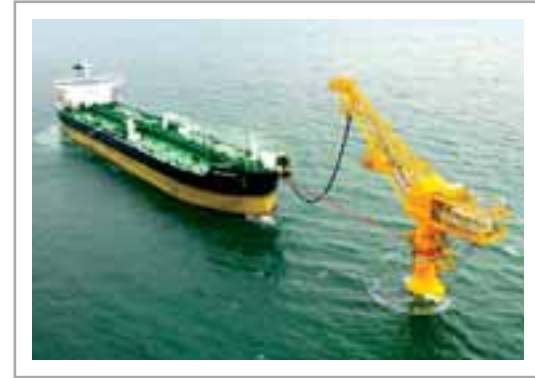
Танкер «Виктор Конецкий» – под погрузкой с выносного погрузочного устройства в порту Де Кастри, октябрь 2006г. / The tanker “Victor Konetsky” loading through the Bow Loading System (BLS) at a Single Point Mooring (SPM) at the Port of De Kastri, October 2006
