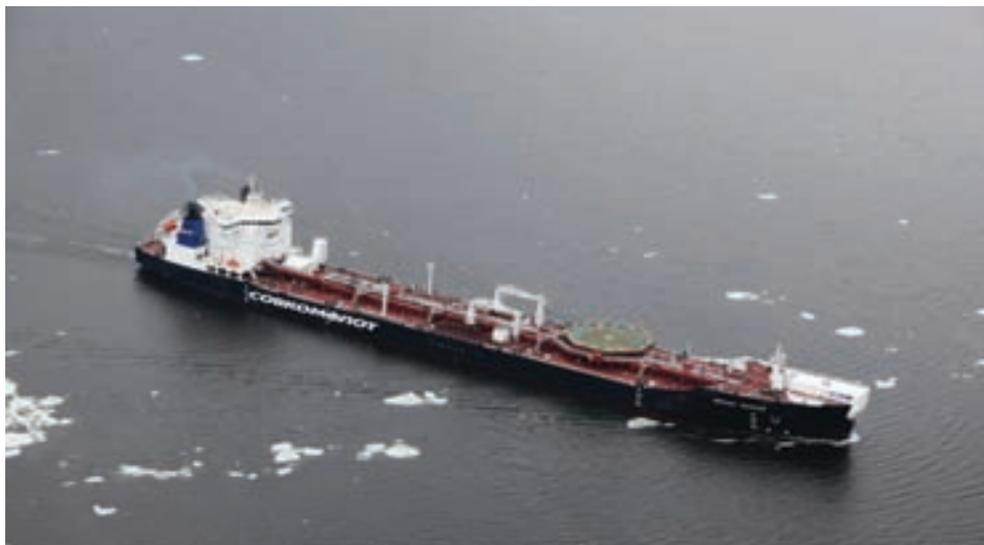
Принят в эксплуатацию танкер "Mikhail Ulyanov", первый в серии арктических челночных танкеров дедейт 70 тыс. тонн, ледового класса LU-6, типоразмера Панамакс, которые были заказаны СКФ на ОАО «Адмиралтейские верфи» (Санкт-Петербург) и специально спроектированы для работы на арктических шельфовых месторождениях России. Такие высокотехнологичные танкеры впервые построены на российском судостроительном предприятии.
