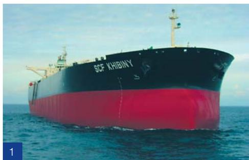
1 / Танкер «СКФ Хибины», дедвейт 159 000 тонн, предназначен для морской транспортировки сырой нефти и нефтепродуктов, принят в эксплуатацию в мае 2002 года
